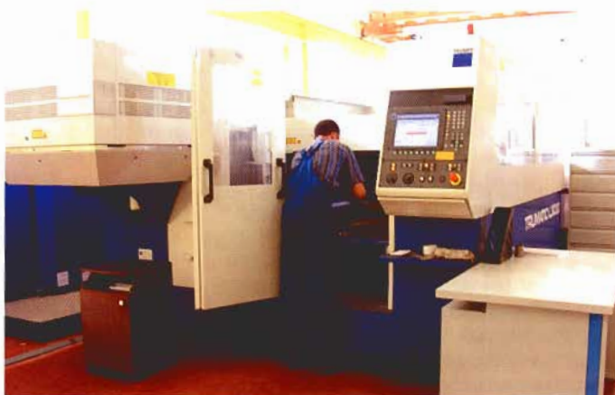
Оператор за лазерной установкой фирмы «Трумф» (Германия) для высококачественного раскроя тонколистового металла на заводе «ТАГРО»
